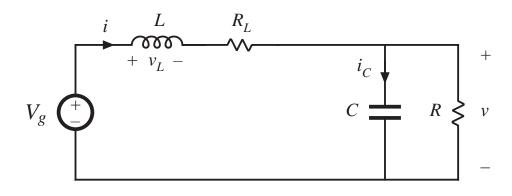
$$v_L(t) = V_g - i(t) R_L - v(t) \approx V_g - I R_L - V$$
