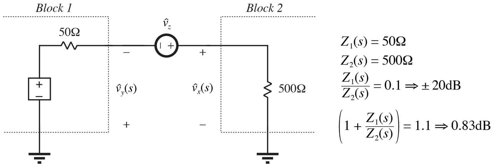
suppose actual  $T(s) = \frac{10^4}{\left(1 + \frac{s}{2\pi \cdot 10\text{Hz}}\right) \left(1 + \frac{s}{2\pi \cdot 100\text{kHz}}\right)}$
