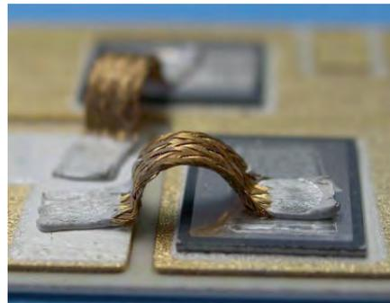
Bild 2.5.2 Gesinterte Silberbänder [31] oder Kupferlitzten [32] als Ersatz für klassische Bonddrahtverbindungen
