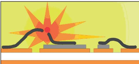
Bild 2.6.7 Möglichkeit des Spannungsüberschlags zum isolierten Temperatursensor beim Schmelzen eines Bonddrahtes im Fehlerfall
