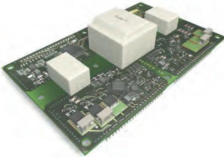
Bild 5.6.16 Platinenansicht der Treiberstufe SKYPER 52 R
